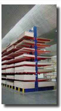
Las estanterías Cantilever son la solución para aquellas unidades de carga no homogéneas en cuanto a dimensiones: Estantería cantilever para tubos, para materiales de la construcción, para tableros de madera, para perfiles, para aluminio, para bobinas, para coches ....
